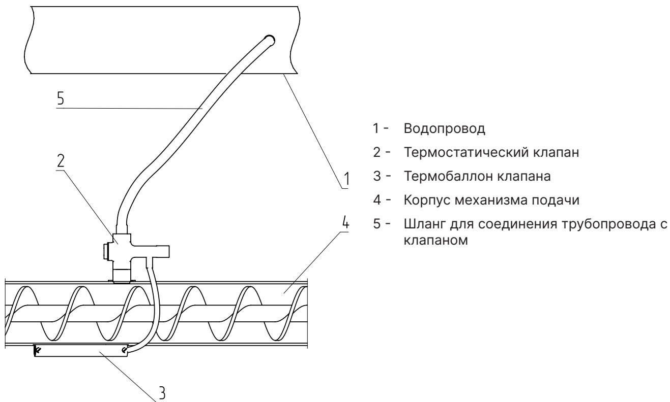
Рис.4 Система охлаждения топливопровода
